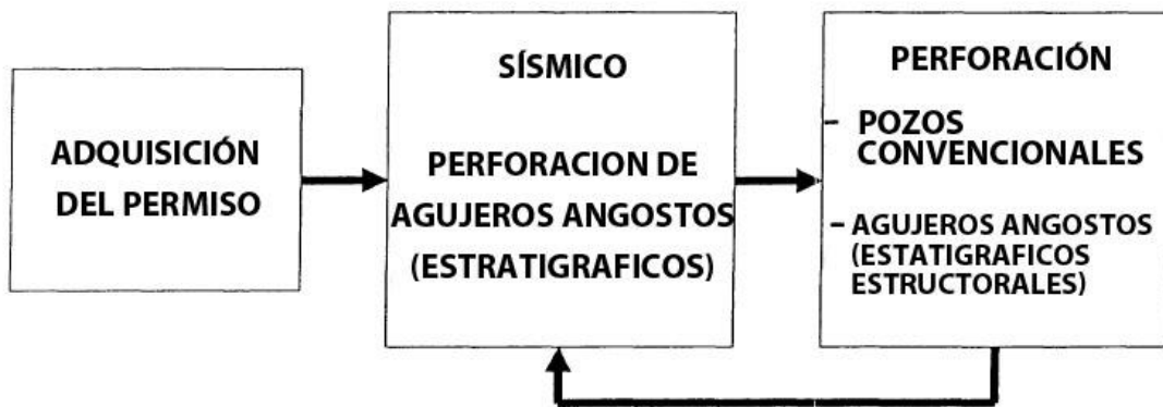
FIG. 5: MODELO DE EXPLORACIÓN UTILIZANDO EL CONCEPTO DE PERFORACIÓN CONTINUA (SEGUN ASHTON).
